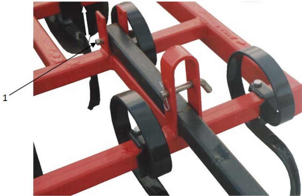
Рисунок 8 Регулировка глубины работы боковых секций
