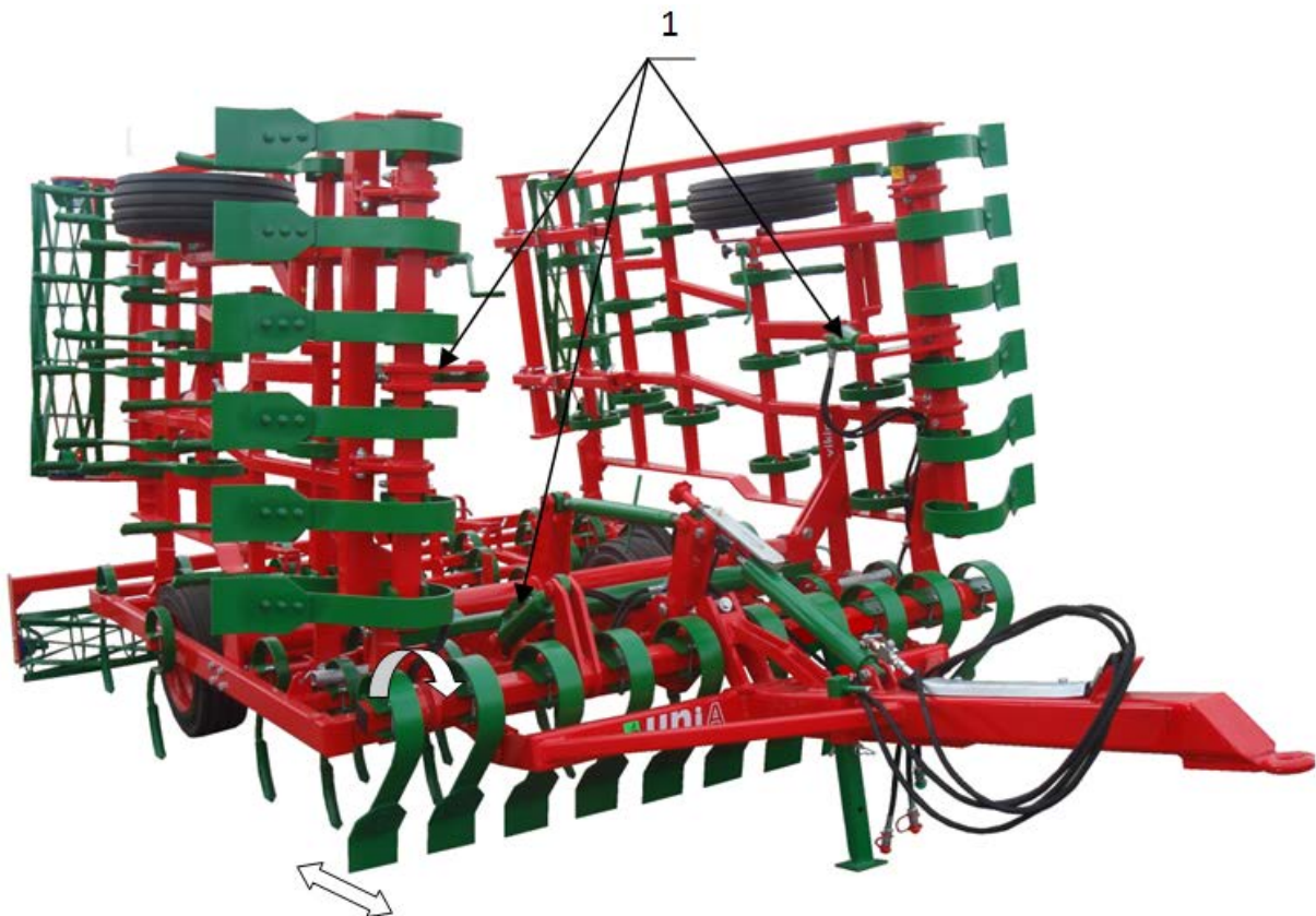
Рисунок 8 Гидравлическая регулировка глубины работы волокуши
