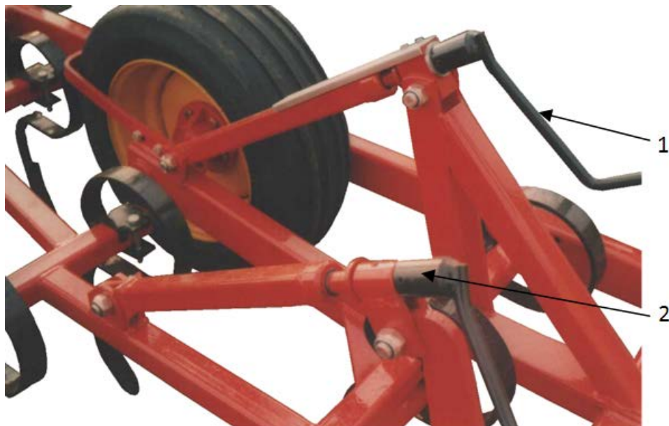
Рисунок 7 Система регулировки глубины работы боковых секций
